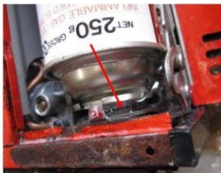
漏石油氣位置
